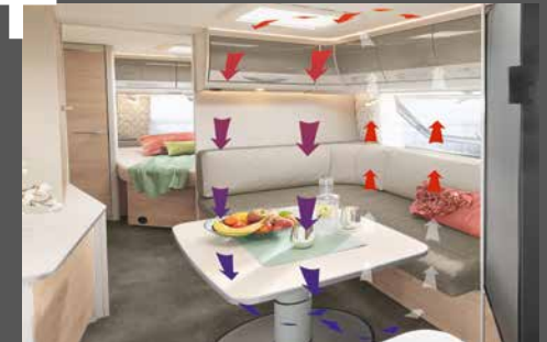
AirPlus – perfekte Luftzirkulation im Innenraum und Hinterlüftung der Dachschränke und Anrichten
